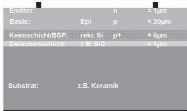
Abb. 2.3: KSD Konzept auf einem Fremdsubstrat (RexWE).
