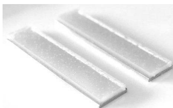
Abb. 4.9: WPI-Gel als Modellverschmutzung
