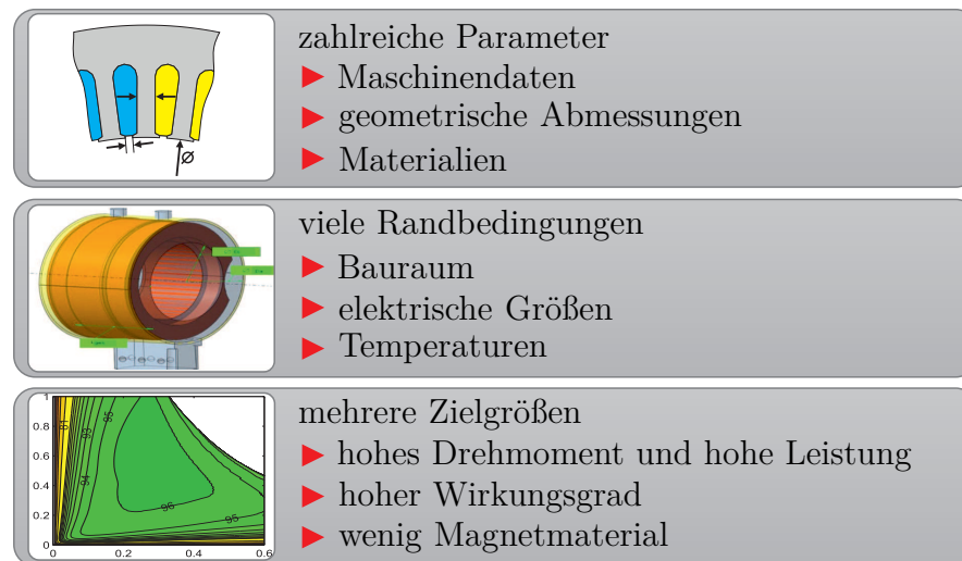
Abbildung 1.3: Herausforderungen bei der Auslegung elektrischer Maschinen für Hybrid- und Elektrofahrzeuge
