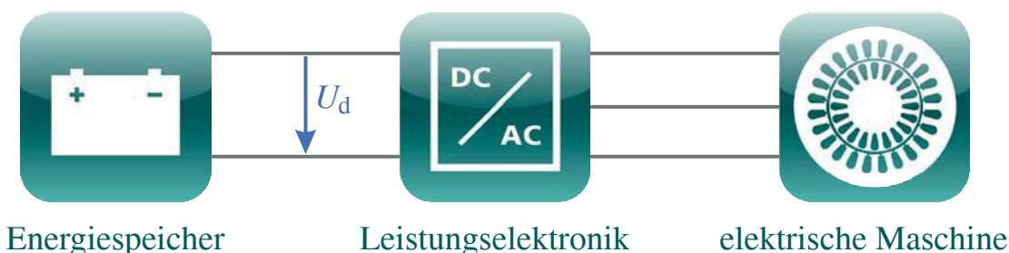
Abbildung 1.1: Prinzipdarstellung des elektrischen Antriebsstrangs in einem Kraftfahrzeug
