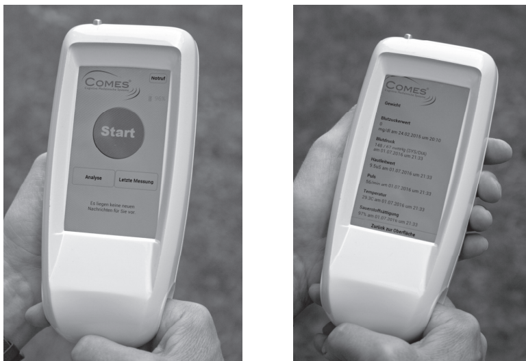
Abbildung 2: All-in-One-Medizingerät. Links: Zum Ermitteln verschiedener Vitaldaten wird der Finger in die Messmanschette im unteren Bereich des Geräts eingelegt und der Start-Button gedrückt. Rechts: Nach kurzer Zeit erscheinen die Daten auf dem Display und werden auf Wunsch per Mobilfunk an die Telemedizin-Plattform COMES® übermittelt.
