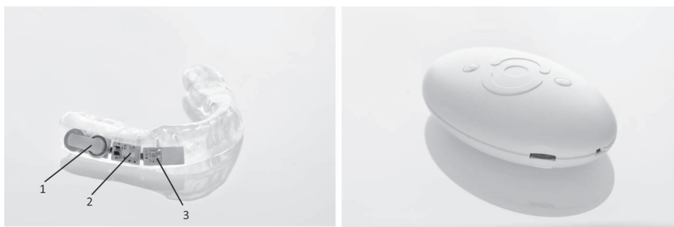
Abbildung 4: Links: Intelligente Zahnschiene mit Batterie (1), Sensorik (2) und Antenne (3). Rechts: Empfänger für den Erhalt der Daten und das Aussenden von Biofeedback (Vibration bzw. Geräusche).
