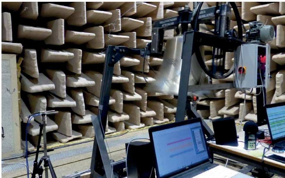
Abbildung 7: Läutemessung an einer Glocke mit verkröpftem Joch im Schalllabor
