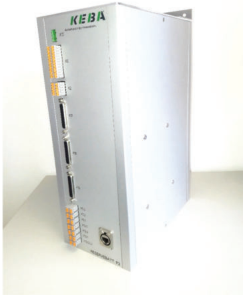
Abbildung 7-21: Neue Steuerelektronik in Pilot 2
