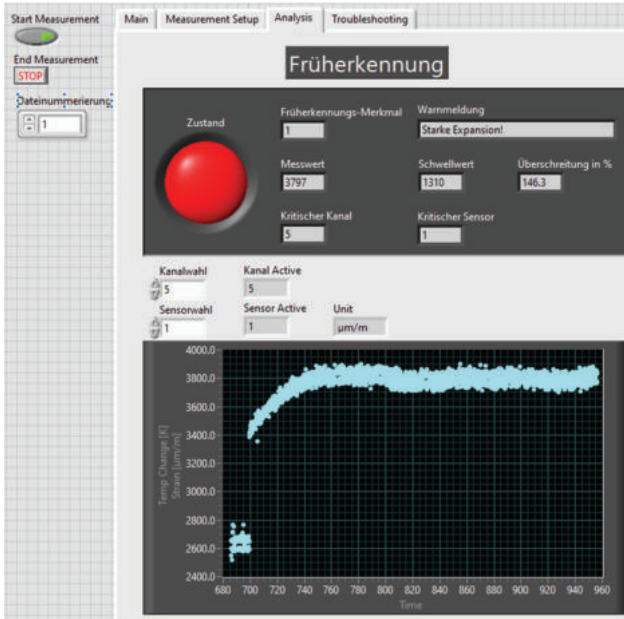
Abbildung 6-36: Software zur Früherkennung einer Havarie
