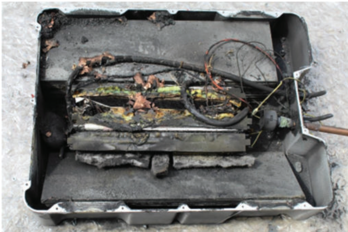
Abbildung 5-18: Batteriegehäuse nach Brandversuch – Innen
