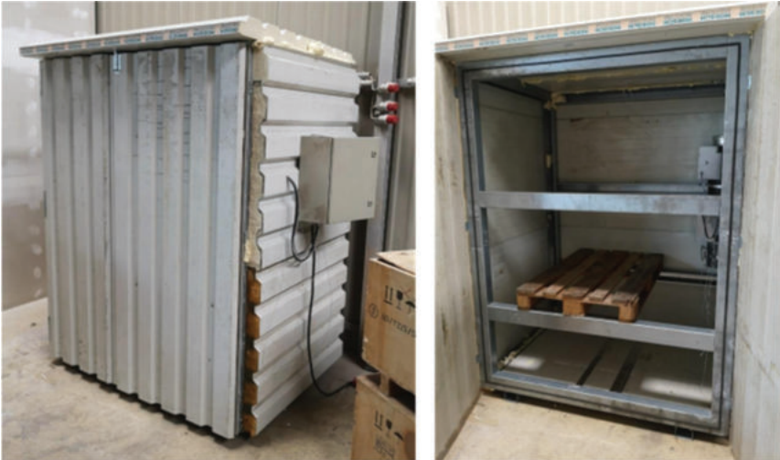
Abbildung 5-24: Klimakammer Außenansicht und Innenansicht
