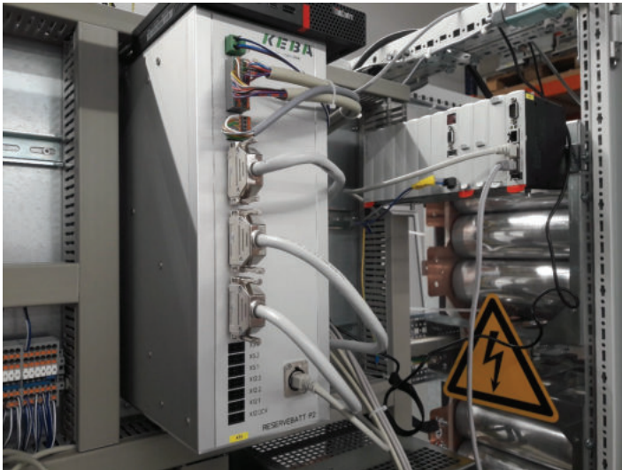
Abbildung 7-22: Integrierte Steuerelektronik inklusive SPS im Piloten 2 mit Testverdrahtung
