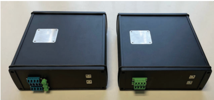
Abbildung 6-32: Messsysteme. Links: Labormesssystem mit LC- und FC/APC-Eingängen. Rechts: Feldversuchssystem mit LC-Eingängen.
