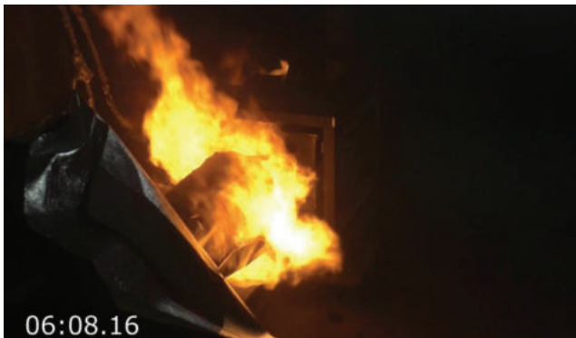
Abbildung 5-49: Stichflamme thermisches Durchgehen - BV mit BS
