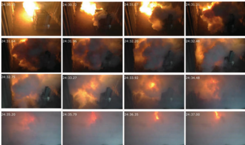
Abbildung 5-33: Bildreihe von starker Ausgasung – BV ohne BS
