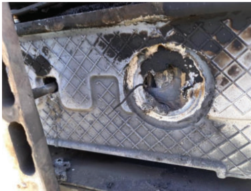
Abbildung 5-39: Berstmembran nach dem Versuch – BV ohne BS
