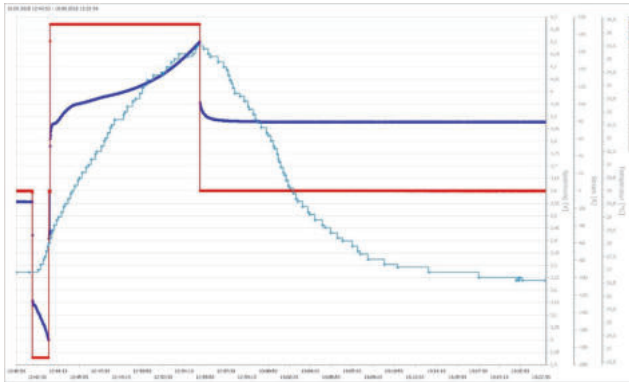
Abbildung 3-53: Spannung(s)-blau, Strom(-rot) und Temperaturverlauf (hellblau) der großformatigen Pouch-Zelle bei 3C-ElaLa Belastung und einfacher Verkabelung
