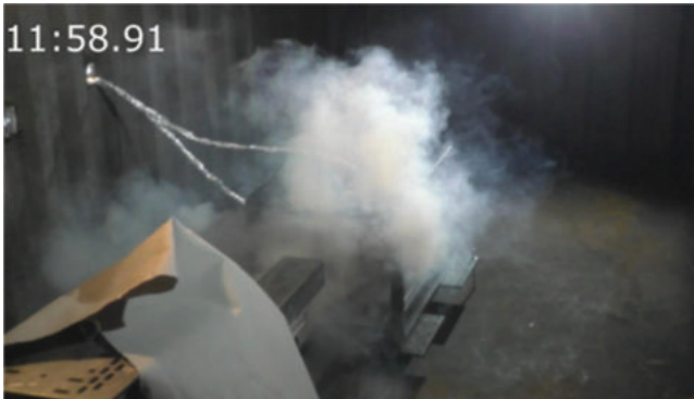
Abbildung 5-29: Erster Gasausstoß – BV ohne BS
