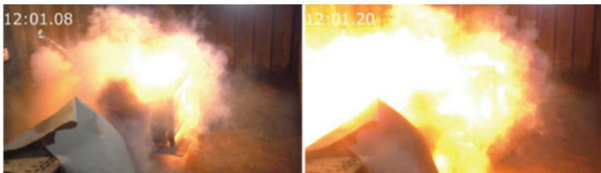
Abbildung 5-30: Entzündung durch Funkenaustritt – BV ohne BS
