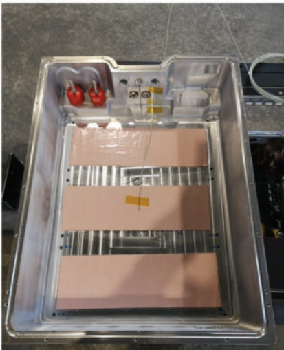
Abbildung 4-7: Sensorpositionierung in dem propagierenden Rack primär an den Modulen (oben), und in den benachbarten Racks am Boden und Deckel (unten).
