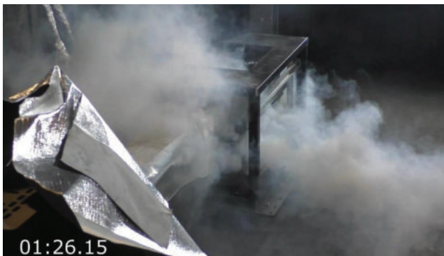
Abbildung 5-45: Erster Gasausstoß – BV mit BS
