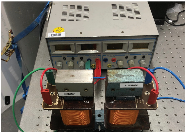
Abbildung 6-18: Aufbau zur Erzeugung magnetischer Felder
