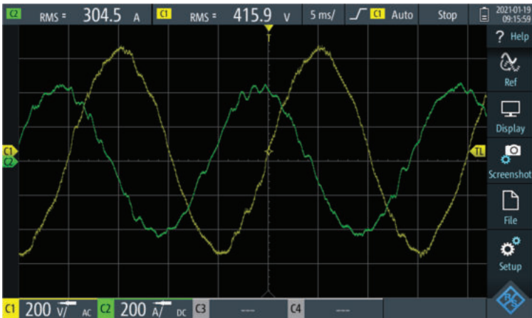
Abbildung 7-29: Stationärer Teillastbetrieb kapazitiv
