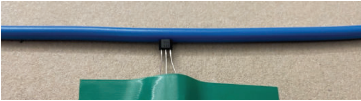
Abbildung 6-22: Hall-Sensor an einem stromdurchflossenen, elektrischen Leiter
