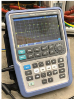
Abbildung 8-21: Erfolgreiche grundlegende Inbetriebnahme des Schaltschranks von Pilot 2 im KEBA-Labor – Oszilloskopaufnahme der getakteten Ausgangsspannung des Stromrichters mit Hysterese-Modulen
