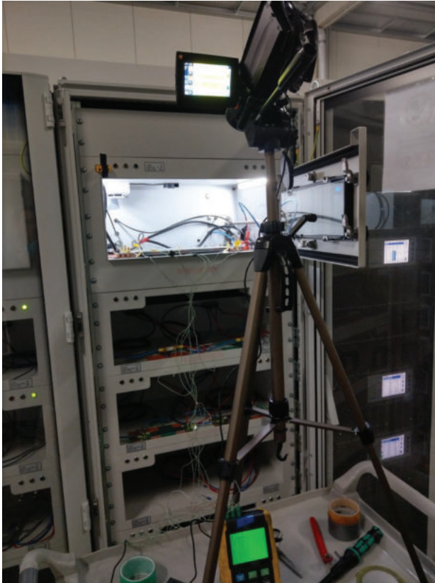
Abbildung 3-52: Aufbau der thermischen Belastungstests mit der Prüfkammer 30 des FuelCon-Prüfstandes, der Wärmebildkamera Testo-885 auf einem Stativ und dem schwarzgelben portablen Temperaturlogger
