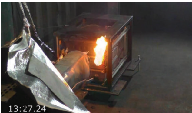
Abbildung 5-51: Abbrandverhalten von 09:40 – 20:50 – BV mit BS
