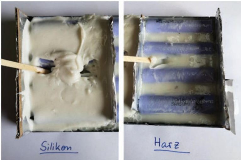
Abbildung 5-9: BSVM Typ 1 und Typ 2 im Batteriegehäuse
