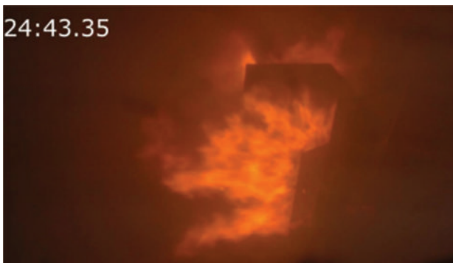
Abbildung 5-34: Explosionsartige Verbrennung – BV ohne BS
