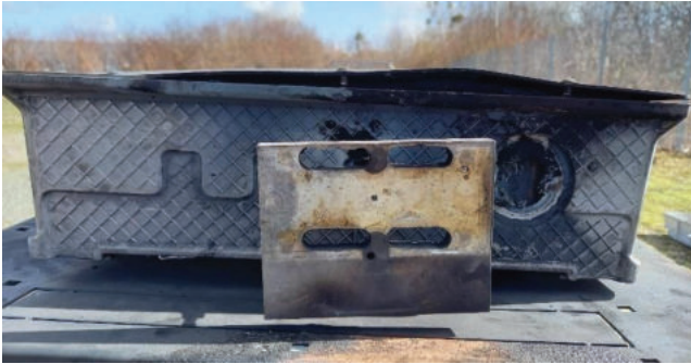
Abbildung 5-40: Rückseite Havarie-Rack – BV ohne BS
