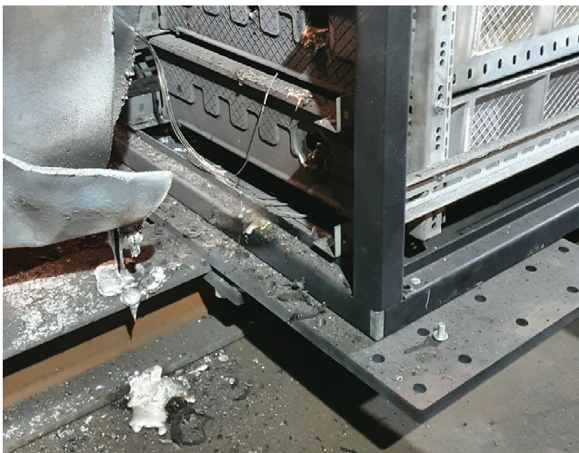
Abbildung 5-57: Metallrückstände neben dem Prüfling – BV mit BS
