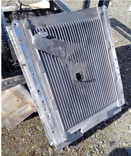
Abbildung 5-44: Unterseite havariertes Rack – BV ohne BS
