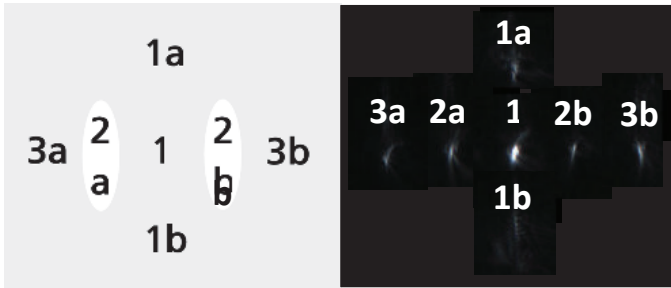
Abbildung 6-12: Links: schematische Facettenansicht mit den elliptischen Laser-Linien. Rechts: Gemessene Transmission bei konstanter Belichtungszeit.
