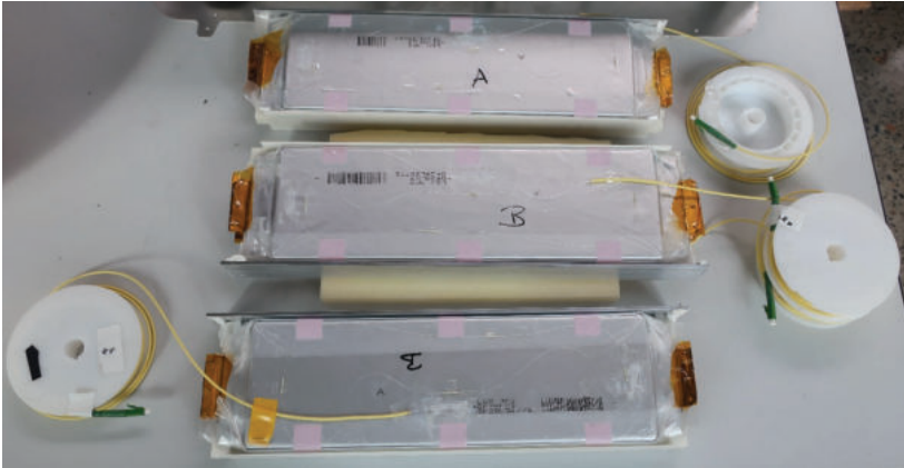
Abbildung 6-38: Mit faseroptischen Sensoren ausgestattete Bi-Packs.
