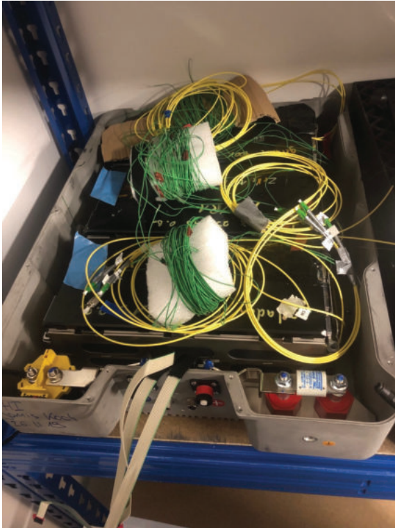
Abbildung 6-41: Mit Temperatur- und Dehnungssensoren versehene PHEV2-Module in einem Rack
