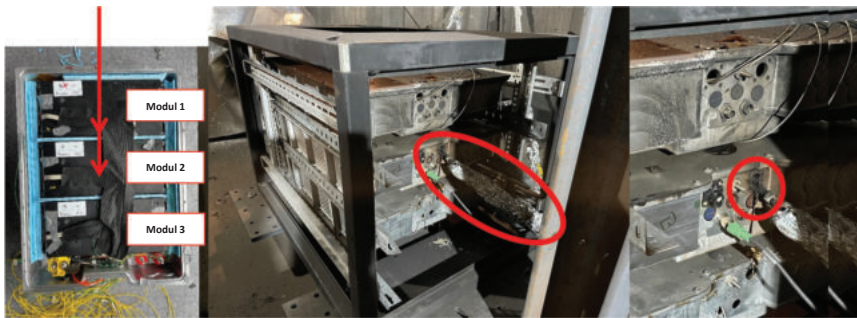
Abbildung 6-63: PHEV2-Module bei Nagelpenetrationstest
