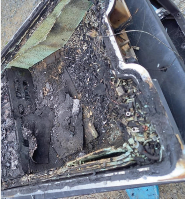
Abbildung 5-62: Kühlmaterial nach Brandversuch – BV mit BS
