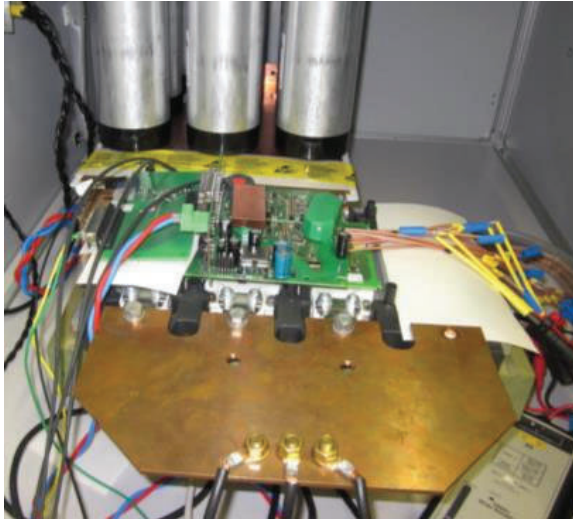
Abbildung 8-11: Laboraufbau mit ILM-Testvehikel
