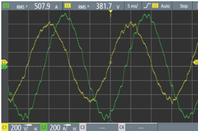
Abbildung 8-23: Messergebnis Inbetriebnahme Gesamtsystem mit Stromrichter von Pilot 2 – beispielhafter Arbeitspunkt mit IAC,RMS=508 A (Einphasige Messung; C1: Netzspannung, C2: Phasenstrom)
