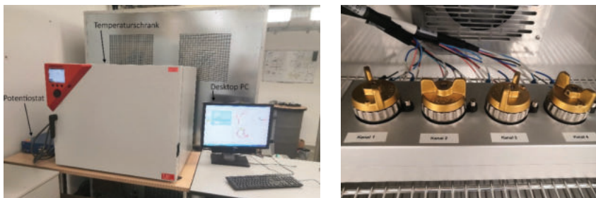
Abbildung 3-47: Im Projekt aufgebauter Versuchstand zur Charakterisierung von Laborzellen – links: Temperaturschrank KT115 der Fa. Binder, Potentiostat VSP3 der Fa. BioLogic und dem Steuerungsrechner, rechts: PAT-Stand-4 mit 4 Laborzellen der Fa. EL-Cell
