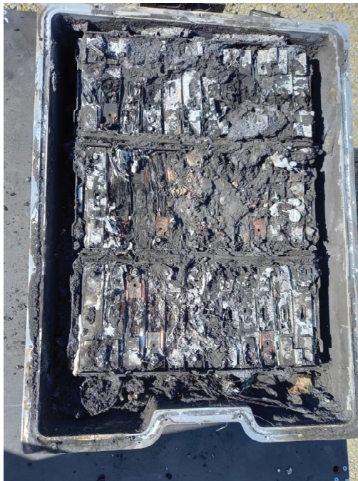
Abbildung 5-43: Blick in havariertes-Rack – BV ohne BS
