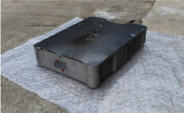
Abbildung 5-17: Batteriegehäuse nach Brandversuch – Außen
