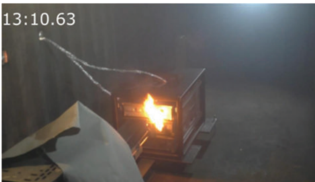
Abbildung 5-32: Leichte Flammenbildung zwischen Havarie – BV ohne BS
