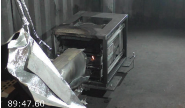
Abbildung 5-52: Flammenbildung nach knapp 90 Minuten – BV mit BS
