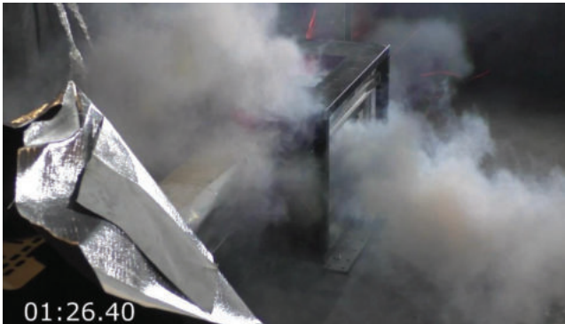
Abbildung 5-46: Funkenaustritt ohne Entzündung: BV mit BS
