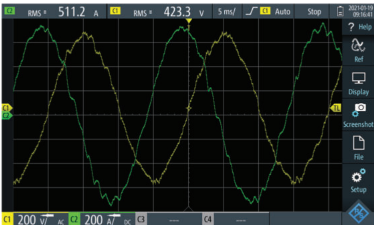
Abbildung 7-30: Stationärer Volllastbetrieb kapazitiv (über 300 kVAr zum Netz)
