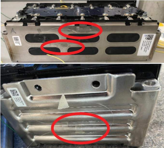
Abbildung 6-39: PHEV2-Modul. Die roten Bereiche zeigen die zu vermessenden Bereiche. Entlang der langen Seite (oben) gibt es zwei Paare, entlang der kurzen Seite (unten) ein Paar aus jeweils einem Dehnungs- und Temperatursensor.
