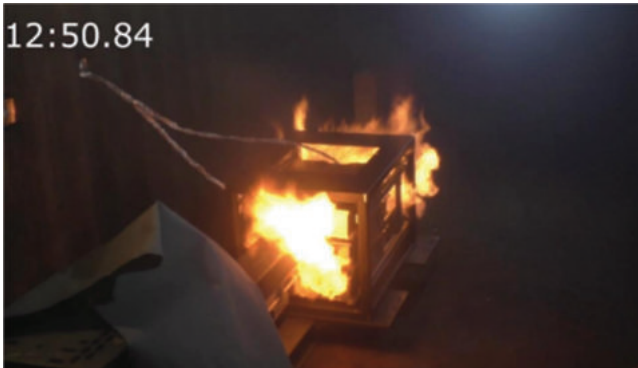
Abbildung 5-31: Stichflammen außerhalb des Gehäuses – BV ohne BS
