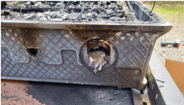
Abbildung 5-58: Berstmembran nach dem Versuch – BV mit BS
