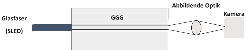
Abbildung 6-11: Aufbau zur Messung der Transmissivität von Wellenleitern
