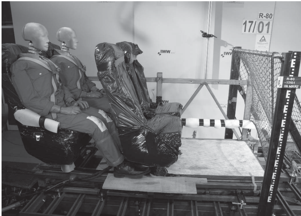
Abbildung 1: Versuchsaufbau des dynamischen Tests
