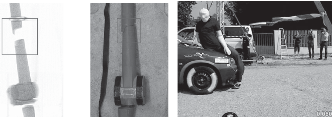
Abbildung 6: links: Gegenüberstellung CT-Aufnahme und freigelegter Oberschenkel des Biofidel-Dummys; rechts: Anprall der Motorhauben-Vorderkante des Pkw mit rund 53 km/h gegen den Oberschenkel
