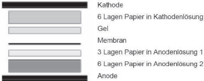
Abbildung 2.8: Schematischer Aufbau der Western-Blot Apparatur.
