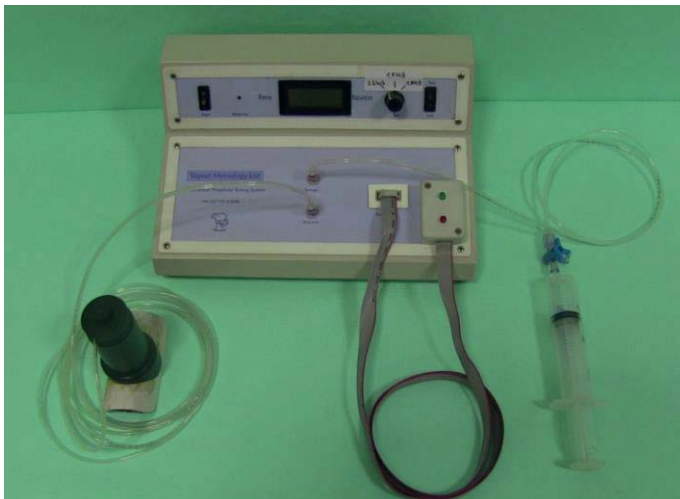
Abb. 3: Das mechanische Reizschwellsystem (MT1), bestehend aus der Steuer- und Anzeigeeinheit, der Kontrolleinheit und dem pneumatischem Krafterzeuger.
