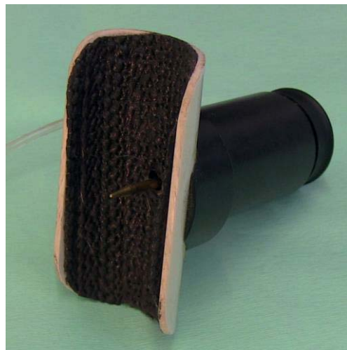
Abb. 4: Der pneumatische Krafterzeuger des MT1, welcher dorsal am Röhrlbein des Pferdes mittels einer Gamasche befestigt wurde.
