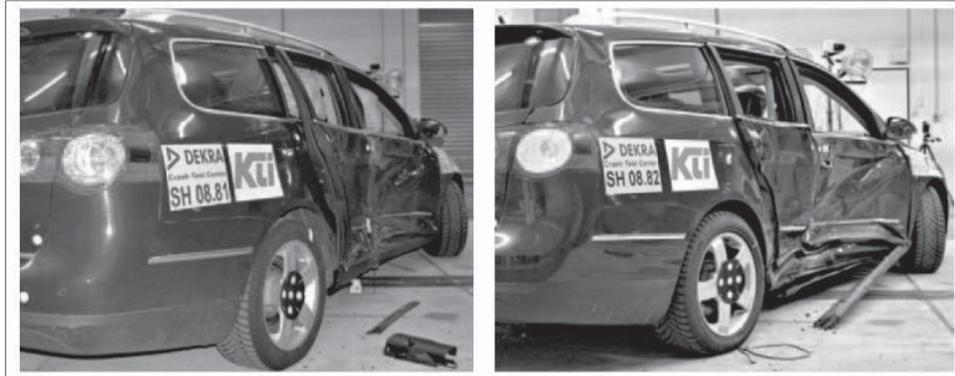
**Abbildung 8: Schäden nach dem Erst-Seitencrash (links) und dem Zweit-Seitencrash eines nicht fachgerecht instandgesetzten Fahrzeugs [3]**
