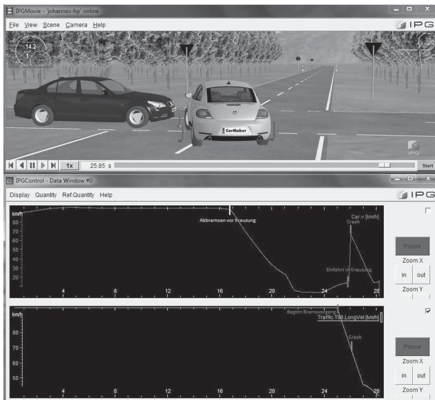
Abbildung 4: Der häufigste Einbiegen/Kreuzen-Unfall in der IPGControl-Diagrammdarstellung
