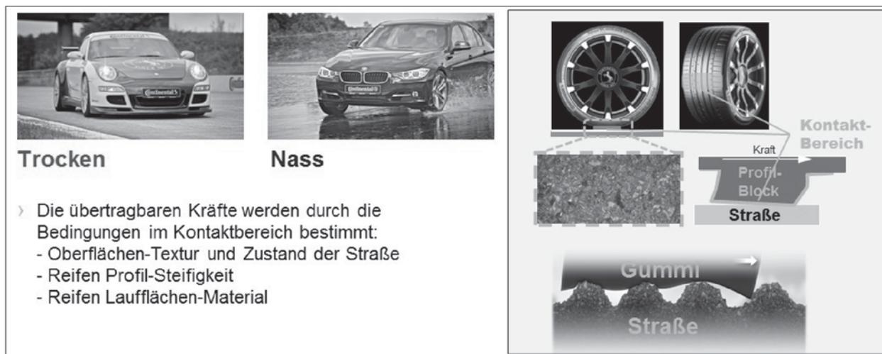
**Abbildung 3: Im Kontaktbereich zwischen Reifen und Fahrbahn werden die Reibkräfte erzeugt, die ein Fahrzeug abbremsen.**
