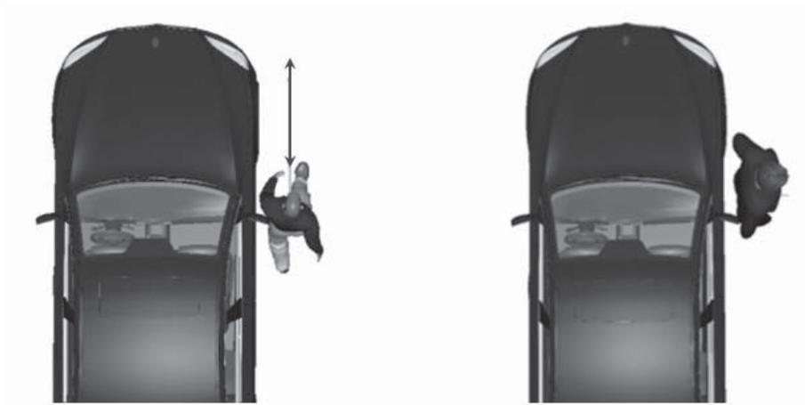
**Abbildung 6: Beispielhafter Unfallverlauf bei Kollisionen eines Fußgängers mit dem Seitenspiegel eines Pkw (links: Fußgänger bewegt sich parallel zum Fahrzeug in Fahrtrichtung; rechts: Fußgänger steht mit dem Rücken zum vorbeifahrenden Fahrzeug)**
