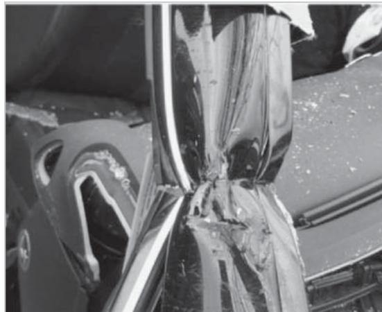
**Abbildung 7: Tertiäre Sicherheit – Probleme beim Trennen einer A-Säule [2]**
