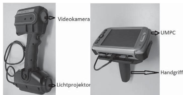
Abbildung 1: MVC- Imager bzw. MVC-Controller
