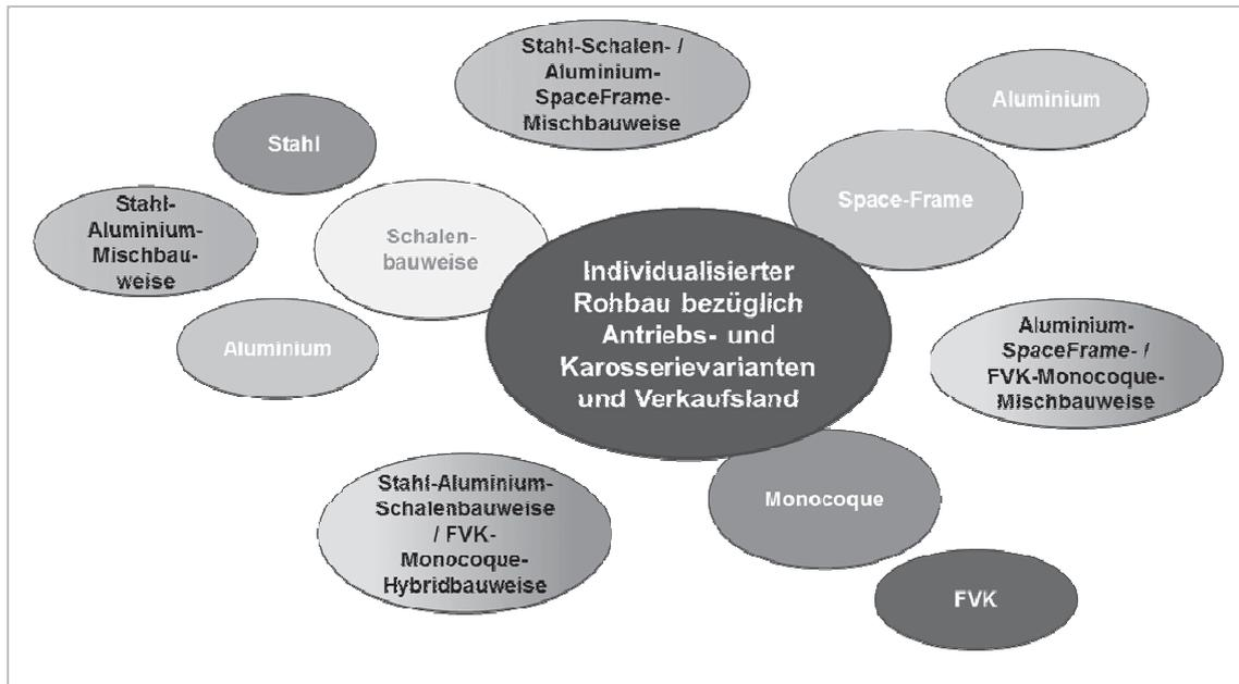
Abbildung 4: Etablierte Rohbaukonzepte im Serienfahrzeugbau
