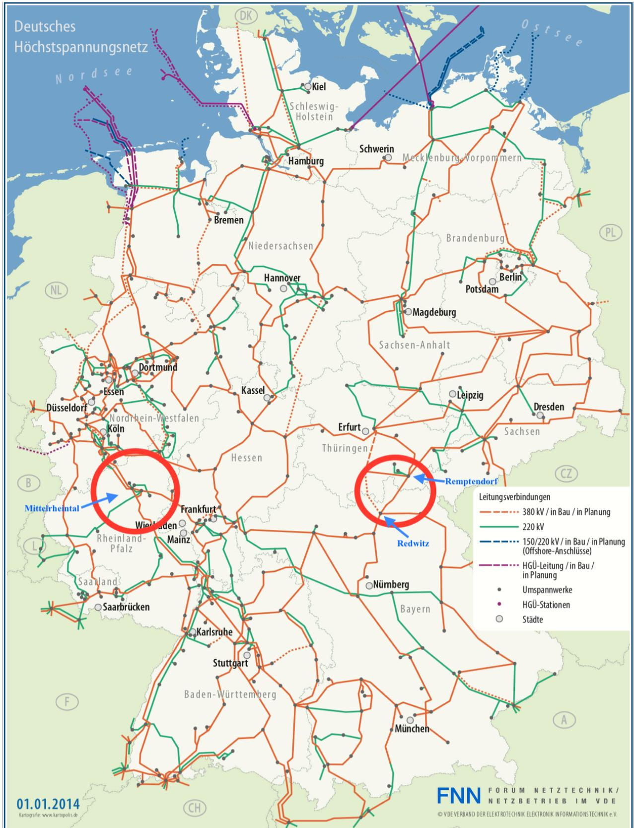
Abbildung10: Nord-Süd Engpässe Übertragungsleitungen (Quelle: VDE FNN<sup>261</sup> – angepasst)
