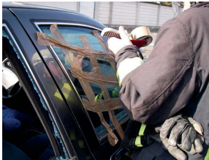
Abbildung 4: Entfernen einer abgeklebten Scheibe
