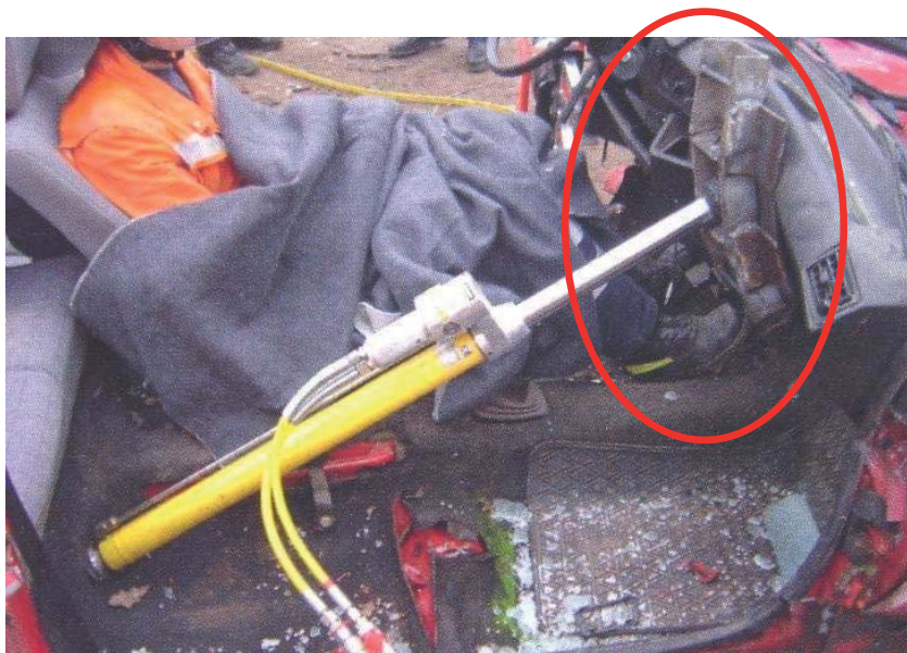
Abbildung 7: Armaturenbrettkralle BF Augsburg [6]
