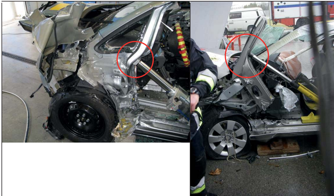
Abbildung 2: li.: A-Säule eingedrückt; re.: A-Säule dreht heraus
