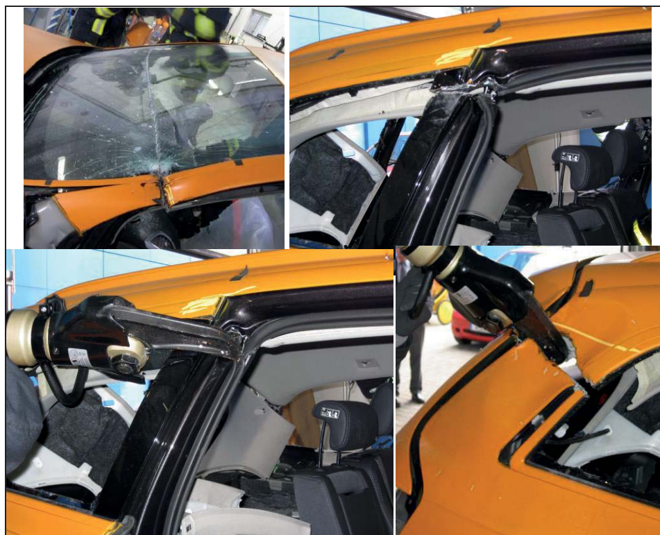
Abbildung 8: Durchtrennen der Fahrzeugsäulen zur Dachabnahme (A-, B-, C-, D-Säule)
