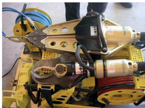
Abbildung 3: Rettungsschere (unten) und Rettungsspreizer (oben)
