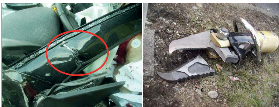
Abbildung 14: Verstärkte Fahrzeugsäule – daran zerstörte Rettungsschere
