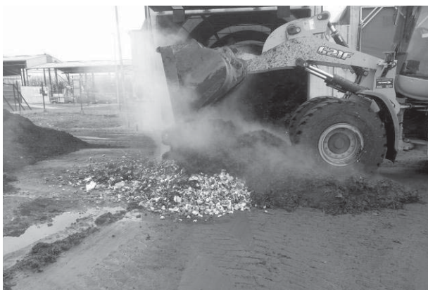
Abbildung 3 und Abbildung 4: Die Materialdurchmischung von Gärrest und MBA-Material mithilfe eines Radladers zeigte Schwächen in der Homogenität der Abfallmischung.
