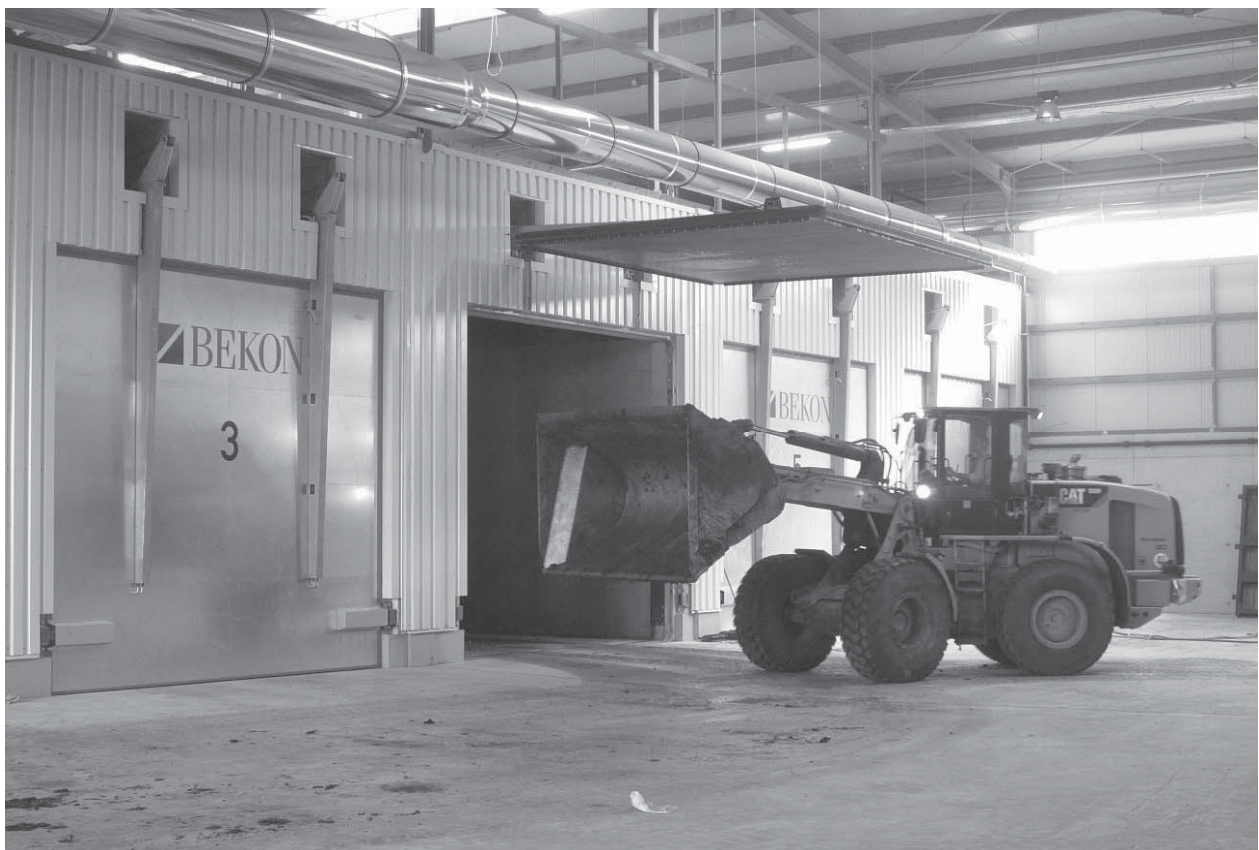
Figure 2: Fermenterbefüllung auf der BEKON-Anlage Iffezheim
