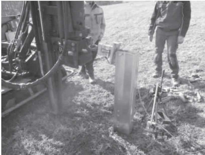
Abbildung 19 Test eines Omega Profils (ca. 20x20 cm) mit Druckstempel und einer Einbindetiefe von 80 cm!
