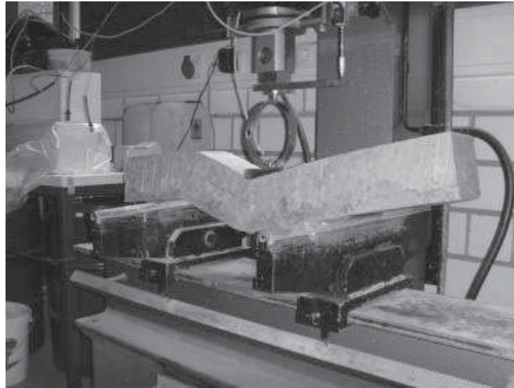
Abbildung 7 Biegezugversuche an mineralischem Dichtungsmaterial
