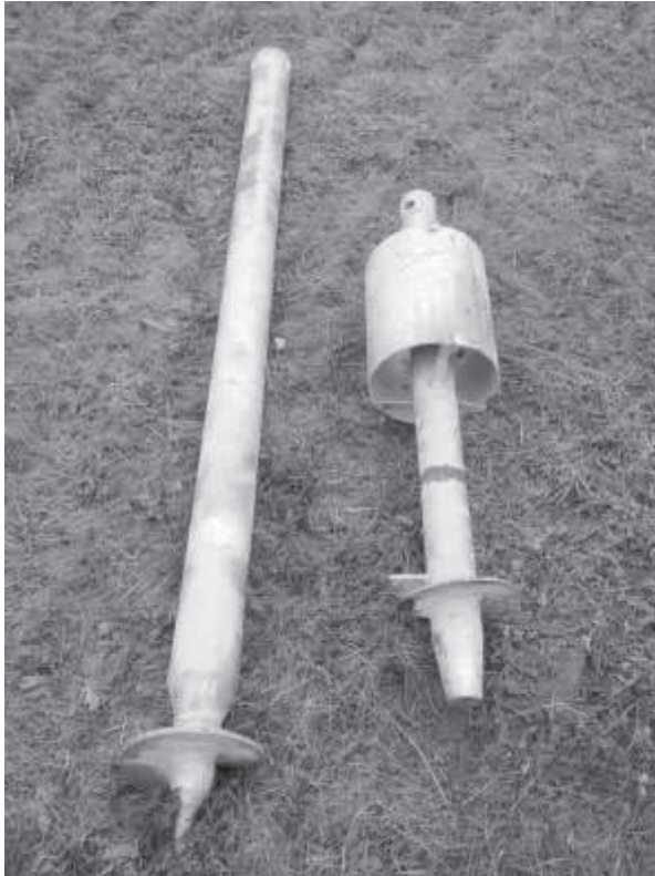
Abbildung 6 Verschiedene einschraubbare Fundamente Das linke Fundament besitzt eine Tonne im Kopfbereich, welche zu höheren horizontalen Widerständen führt.
