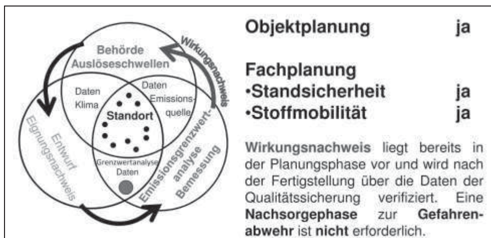
Abbildung 2 Entwurf und Bemessung der Deponiesicherung gemäß dem Prinzip Vorsorge als Teil der Planungsaufgabe: Quantitative Verknüpfung der gewählten Sicherungsmaßnahme mit der Zielvorgabe (Auslöseschwellen) - Wirkungsnachweis.
