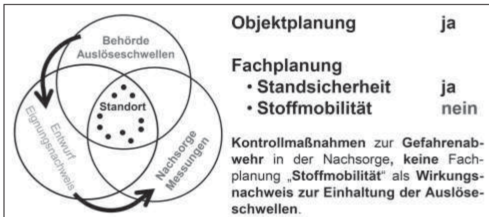
Abbildung 1 Entwurf und Bemessung der Deponiesicherung nach Verordnung, Ist-Situation gemäß dem Prinzip der maßnahmenorientierten Nachsorge, gleichbedeutend dem Begriff „Gefahrenabwehr“.
