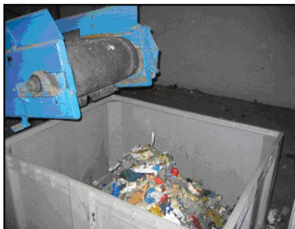
Abbildung 1 Austrag einer angereicherten Versuchsfraction
