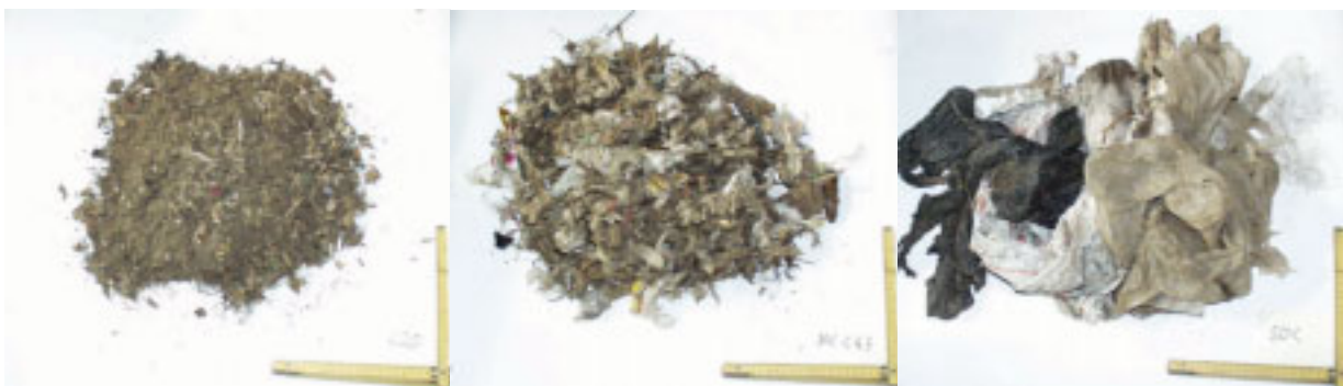
Abbildung 9 Siebfractionen des dynamisch getrockneten Materials
