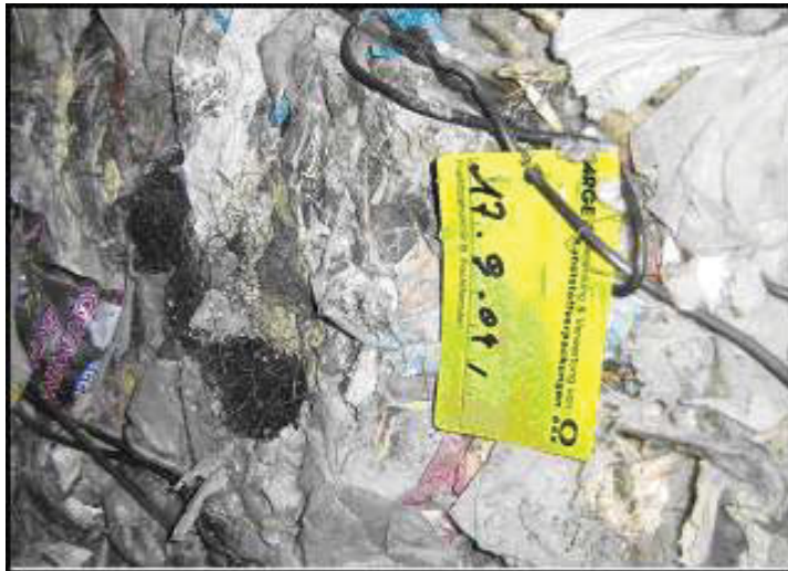
Abbildung 2 Kennzeichnung des Outputs einer Aufbereitungsanlage, Aufbereitungstag 17.09.2004
