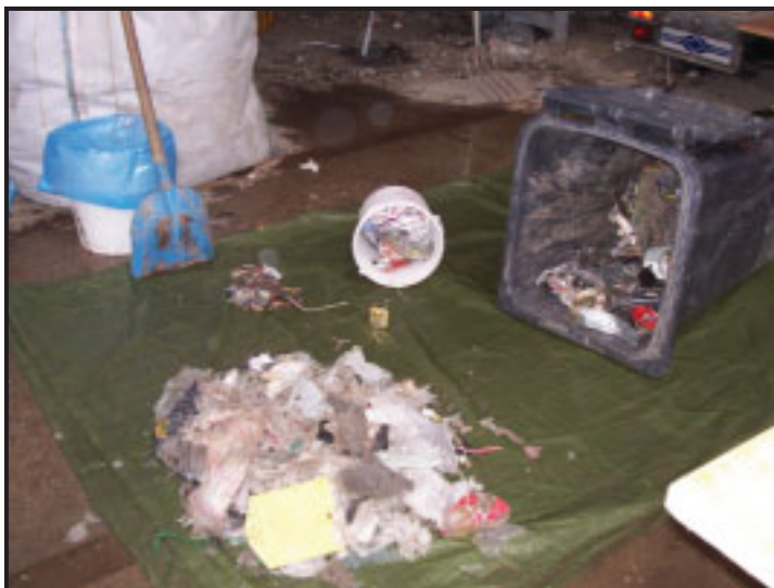
Abbildung 3 Sortierung der Fraktion ferromagnetisch > 80 mm
