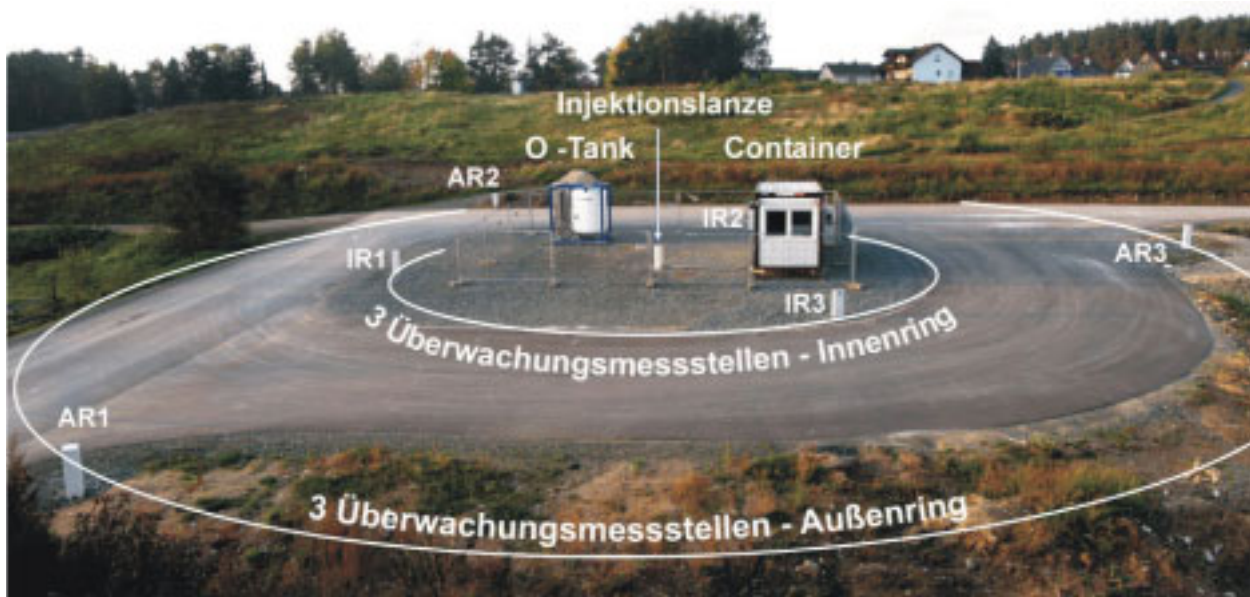
Abbildung 4 Feldversuch zum gasförmigen Sauerstoffeintrag in den GW - Schadensbereich der Deponie Weiden-West
