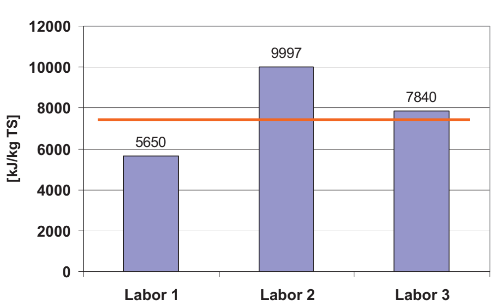
Abbildung 5 Obere Heizwerte einer MBA-Probe, „Ringversuch“
