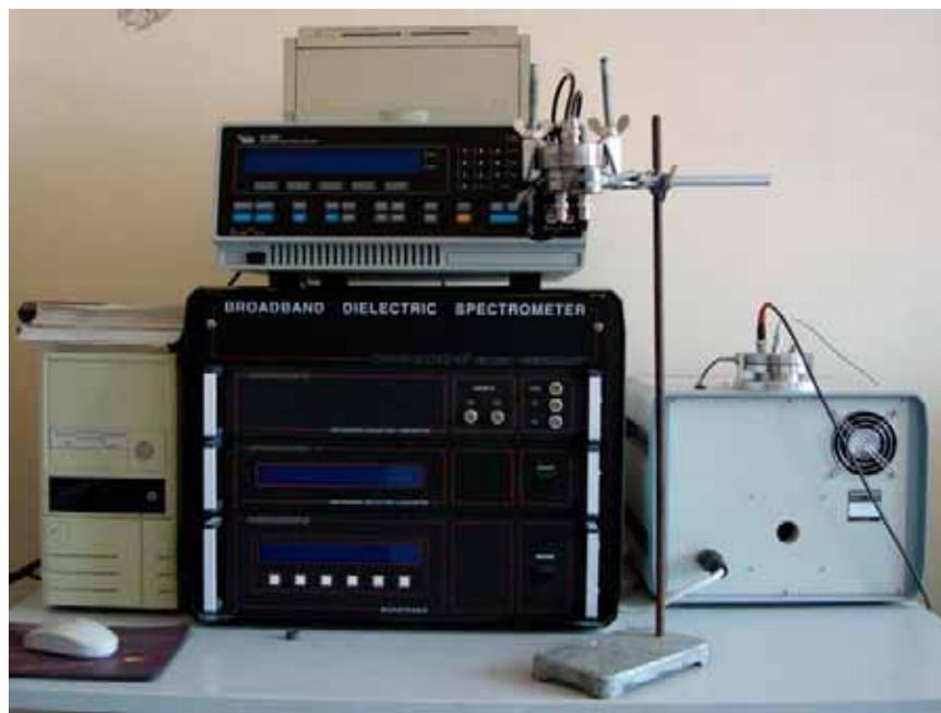
Abb. 8-6: Aufbau Messapparatur Impedanzspektrometer
