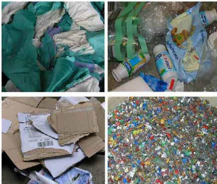
**Abb. 3** Proben aus Recyclingmaterial für Selbstentzündungsversuche
