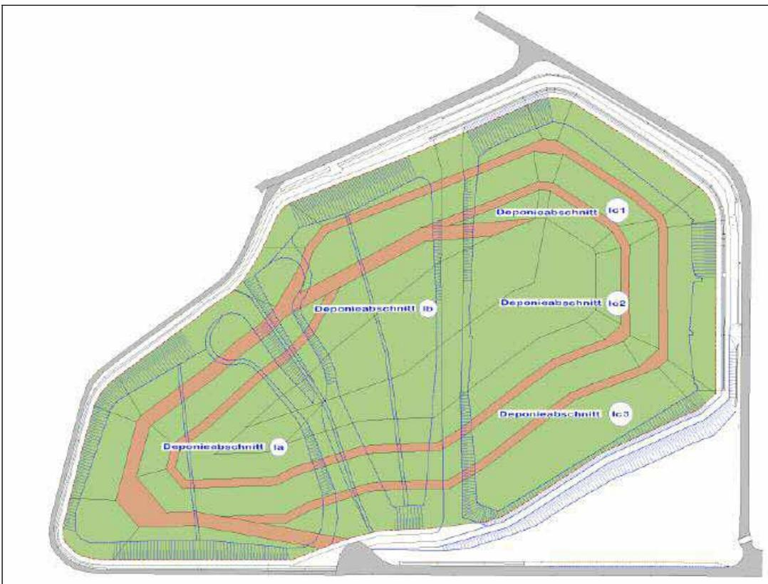
**Abbildung 4: Struktur der Deponie Wilsum – Diagonalausbau**
