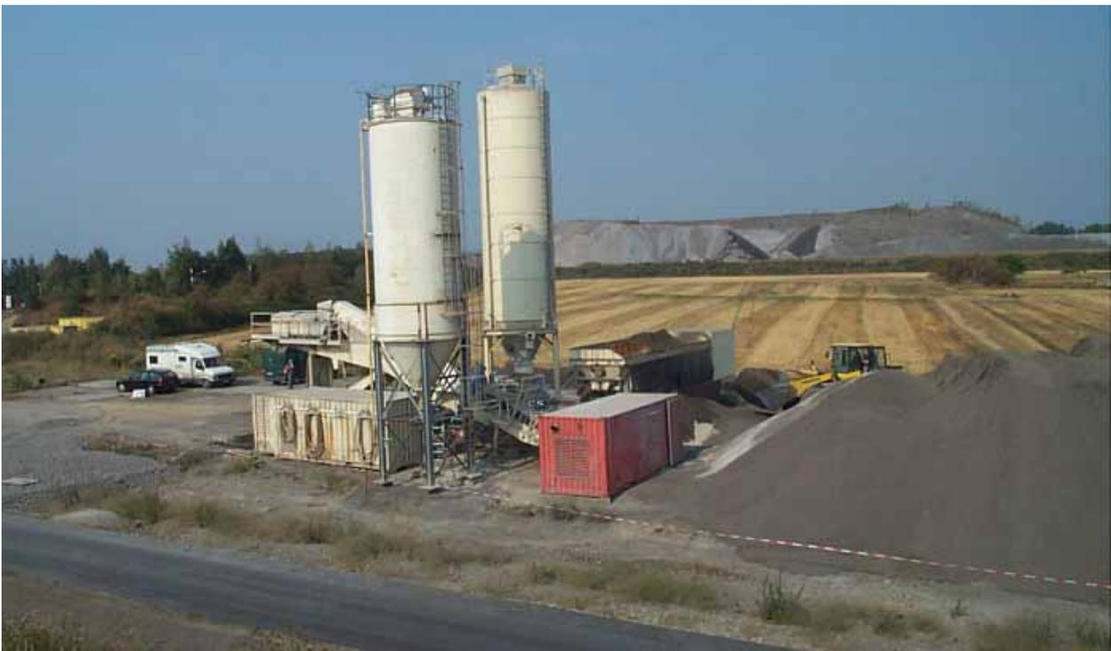
**Abbildung 1** Feldfabrik für die Produktion von Tonschlacken
