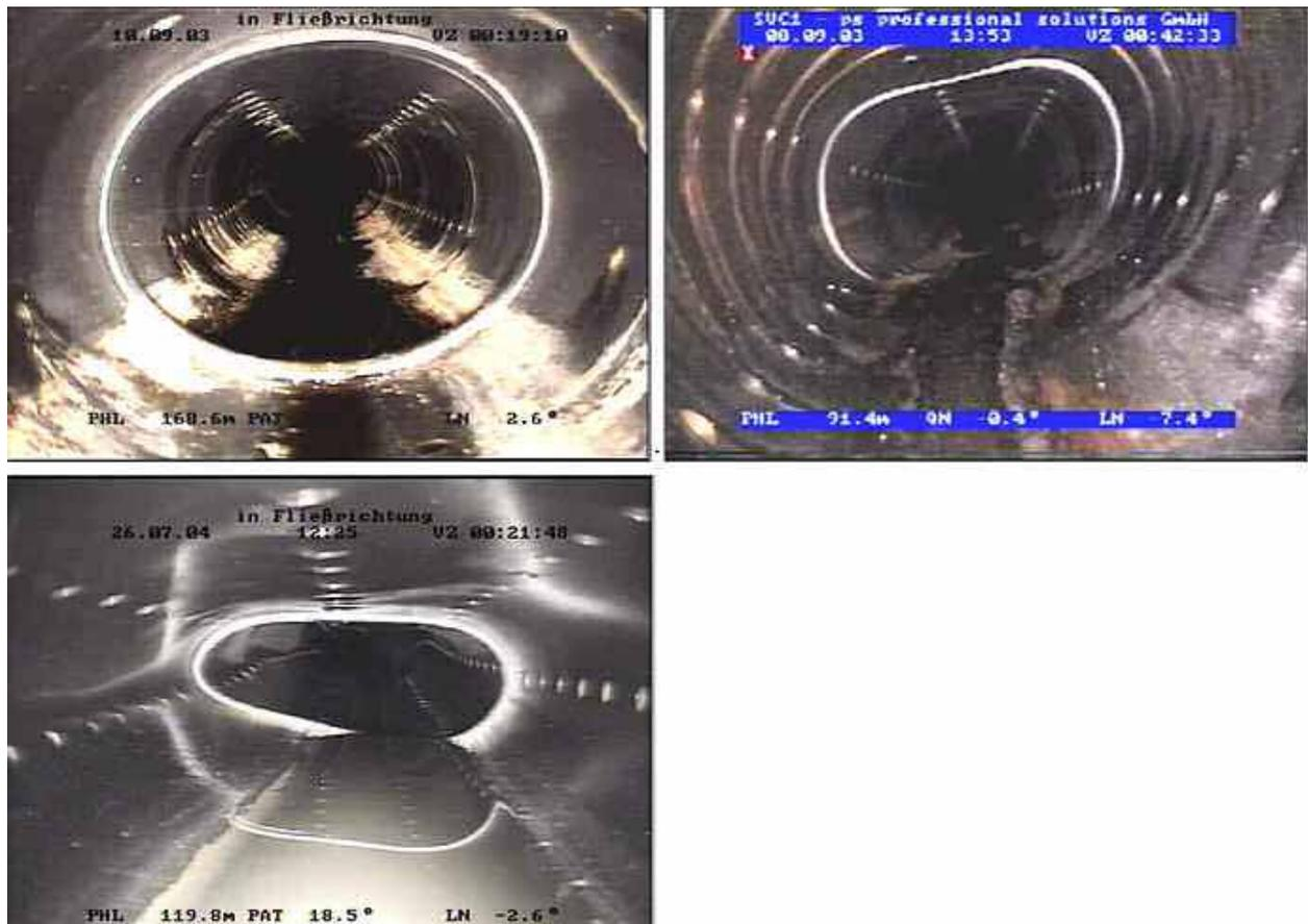
**Abbildung 1, 2 und 3:** Entwicklungsstadien bei der Verformung von PE-Leitungen
