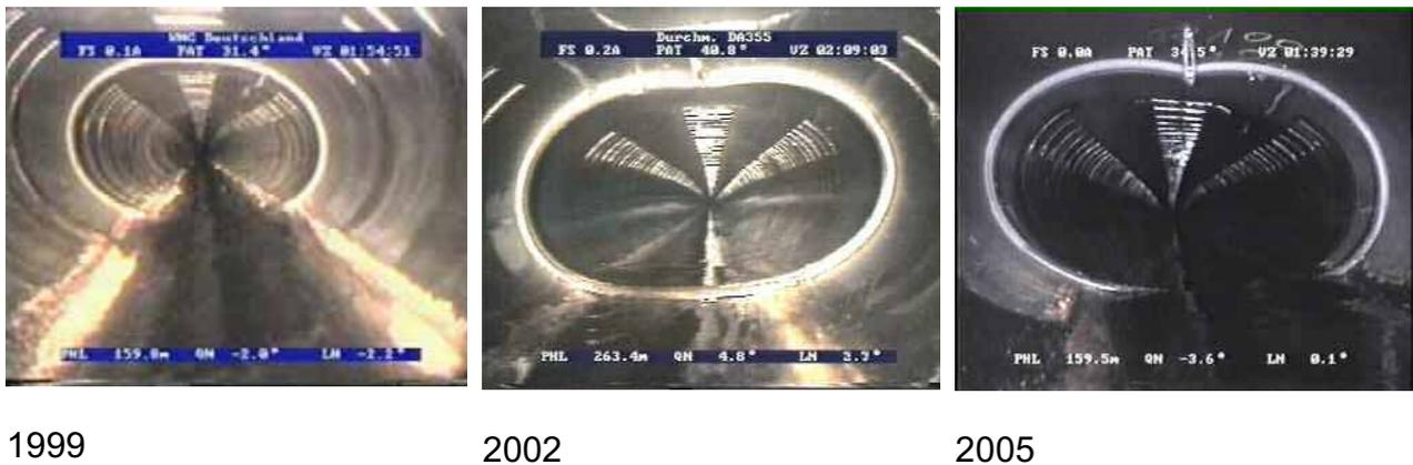
**Abbildung 2:** Deformation der Rohrleitung 1999 bis 2005
