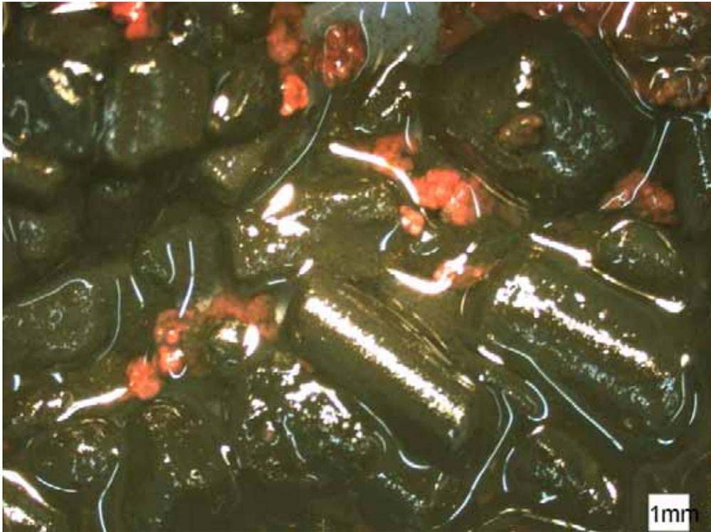
**Abbildung 3:** Probe aus einem Aktivkohleabsorber bei 20-facher Vergrößerung
