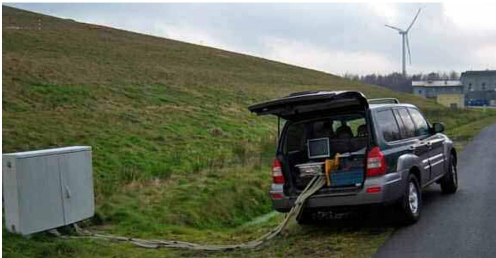
**Abbildung 7** Feldverteiler mit Anschluss einer mobilen Auslese- und Auswerteeinheit (vergleichbare Anordnung auf einer anderen Deponiebaumaßnahme)
